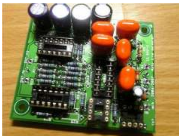
図 7: キャパシタの取り付け
