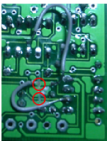
図 4: パターンカット拡大
